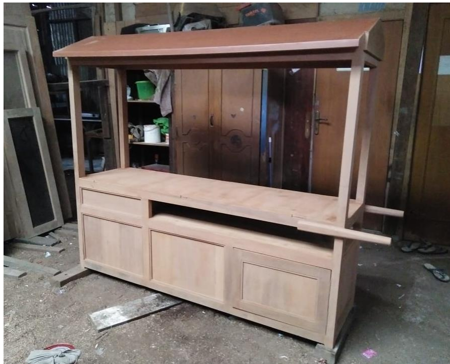
Gambar 20. Gerobak setelah perakitan
