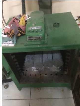
Gambar 3. 1 Perawatan Beton Menggunakan Oven Suhu 60°C
