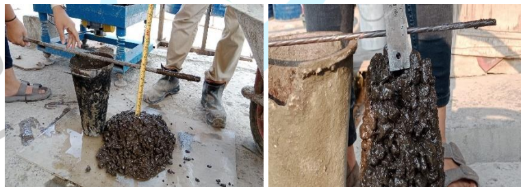
Gambar 4. 4 Pengujian Slump pada Beton Geopolimer
