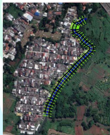
Gambar 3.5 Lateral Structure pada kiri (A) dan kanan (B) sungai, salah satu potongan melintang sungai [Sta. 0+440] (C), serta tampak atas tanggul sepanjang alur sungai (D) pada kondisi penambahan tanggul 1,5 m (Diolah oleh peneliti, 2023)
