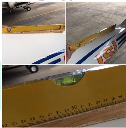
Gambar 3.12 Melakukan pengukuran sudut kemiringan menggunakan waterpass pada Bagian Ekor Pesawat Diamond DA-40 TDI
