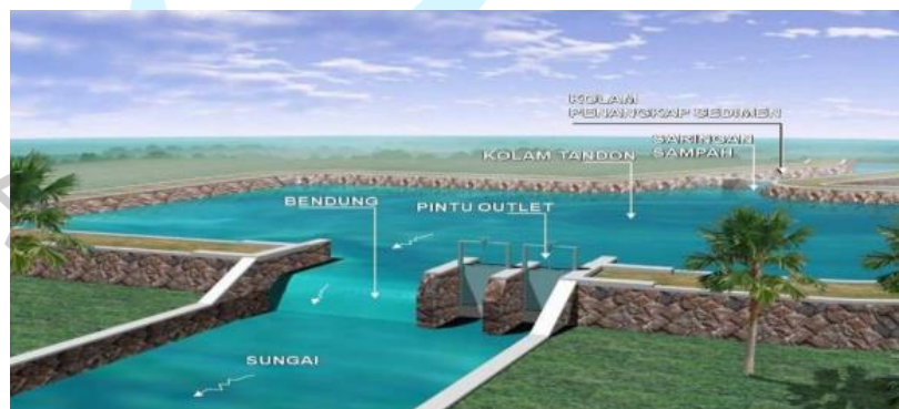
Gambar 2.6 Kolam Retensi di Dalam Badan Sungai (Kementrian PUPR, 2020)
