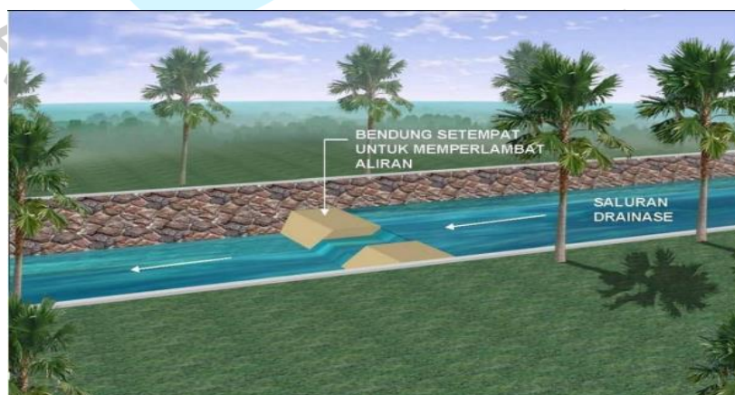
Gambar 2.8 Kolam Retensi di Dalam Badan Sungai (Kementrian PUPR, 2020)
