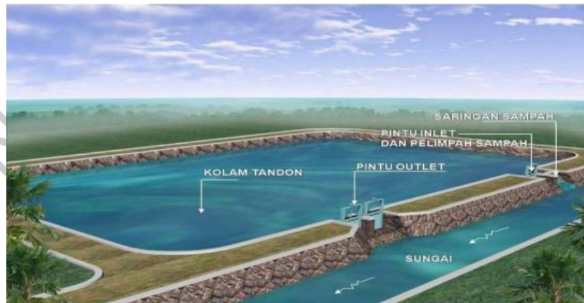
Gambar 2.7 Kolam Retensi di Samping Badan Sungai (Kementrian PUPR, 2020)
