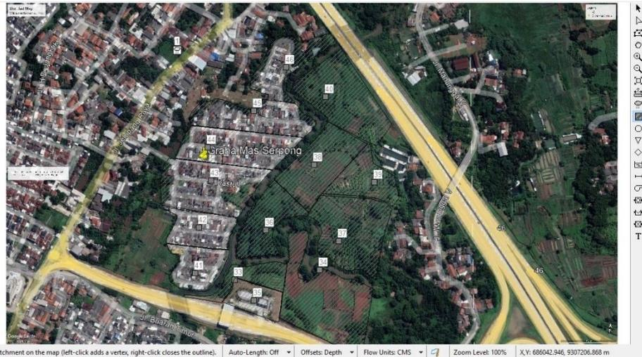
Gambar 4.21 Pembuatan Objek *Subcatchment* pada SWMM 5.2 (Dokumentasi Pribadi, 2023)
