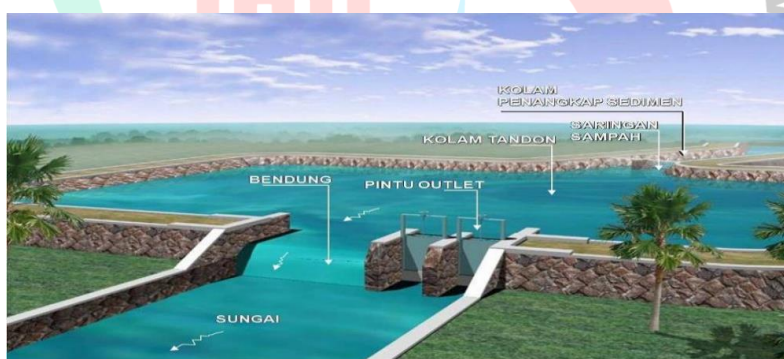
Gambar 2.10 Kolam Retensi di Dalam Badan Sungai (Kementerian PUPR, 2020)
