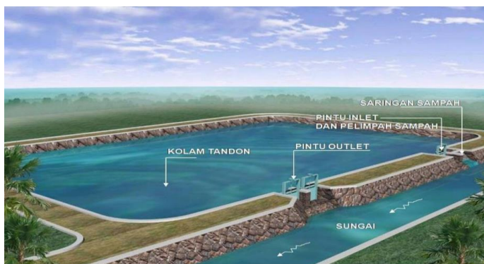
Gambar 2.9 Kolam Retensi di Samping Badan Sungai (Kementerian PUPR, 2020)
