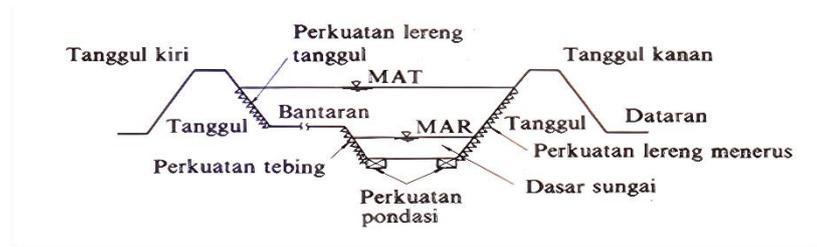
Gambar 2. 11 Pemasangan Perkuatan Lereng/Tebing (Sumber:Kementrian Pekerjaan Umum dan Perumahan Rakyat, 2017)
