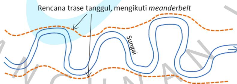
Gambar 2. 2 Rencana Trase Tanggul Dari Aliran Sungai Berbelok-Belok Tajam Meandering (Sumber: Kementerian Pekerjaan Umum dan Perumahan Rakyat, 2017)
