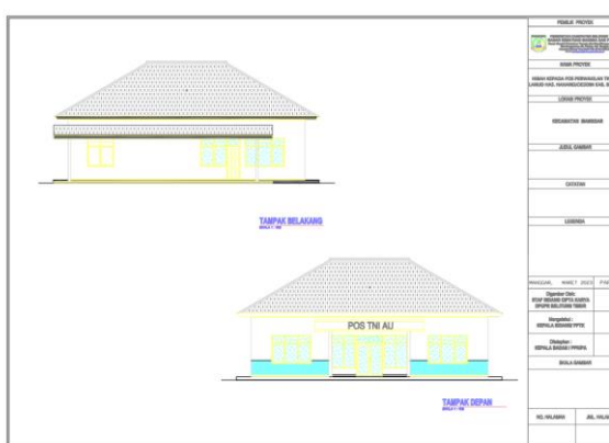
Gambar 3.2.6 Gambar DED Tampak Depan dan Belakang Pos TNI AU Sumber: Pak Andre, Arsitek di Bidang Cipta Karya (2023)
