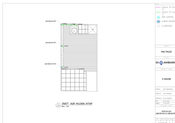
**Gambar 3.66 Instalasi Air Hujan pada Atap**
