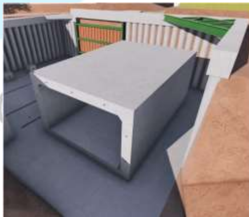
Gambar 3. 27 Segmen Box Tunnel Sumber : (Dokumen PT. Jaya Konstruksi, 2021)
