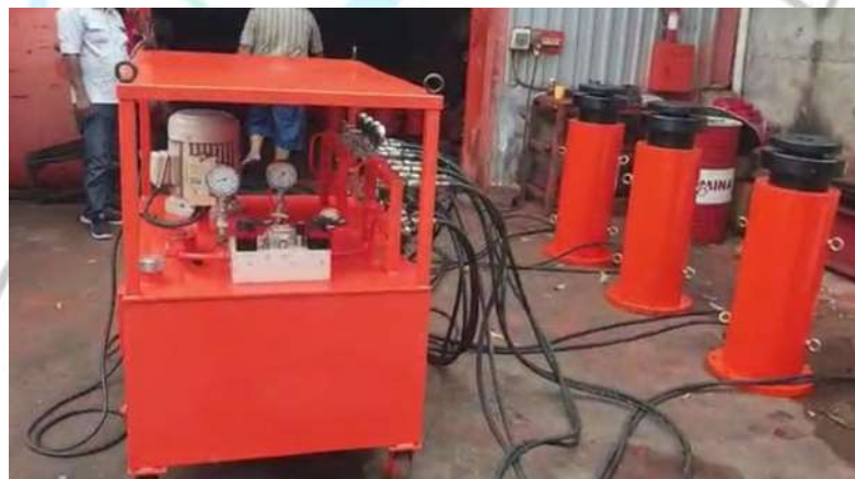
Gambar 3. 49 Synchronize Hydraulic Pump Sumber : (Dokumen PT. Jaya Konstruksi, 2021)
