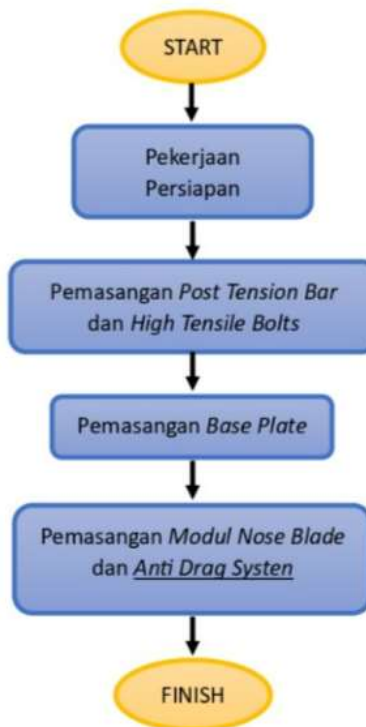
Gambar 3. 33 Nose Blade Sumber : (Dokumen PT. Jaya Konstruksi, 2021)
