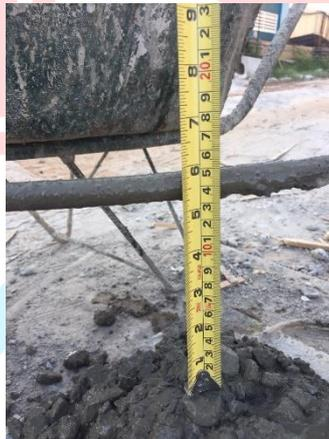
**Gambar 3. 48 Hasil Uji Nilai Slump**
