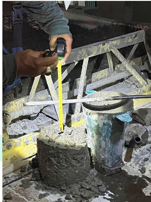
Gambar 3.26 Pengujian Nilai Slump
