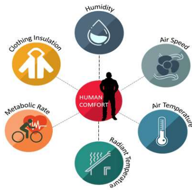
Gambar 2. 1 Faktor-faktor yang mempengaruhi kenyamanan termal Sumber: Thermal Comfort Basics: What is ASHRAE 55? | SimScale Blog
