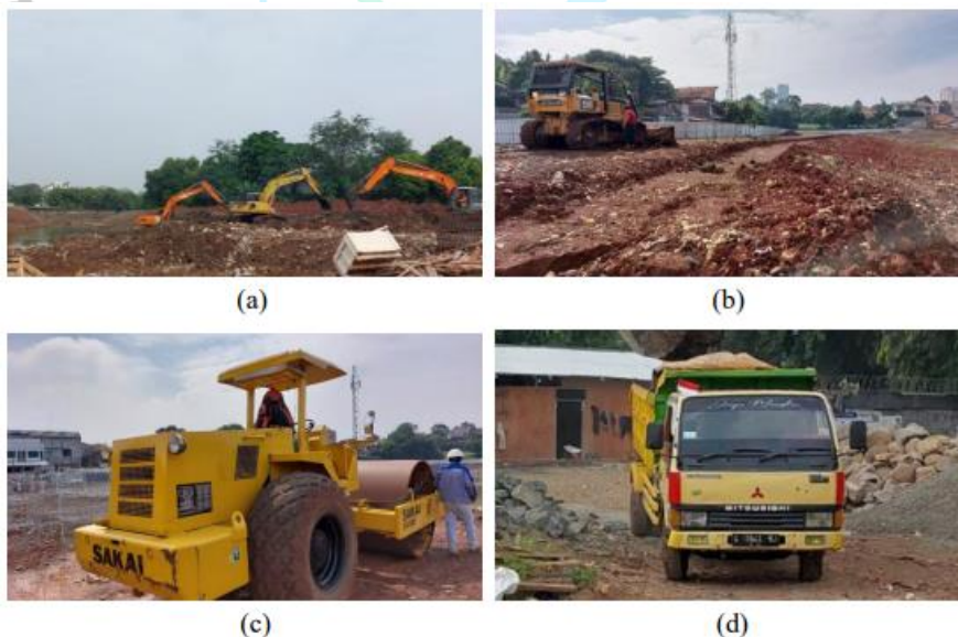
Gambar 3. 13 Alat berat utama: (a) Ekskavator, (b) Bulldozer; (c) Roller Vibro; (d) Dump Truck
