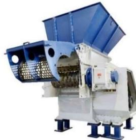
Gambar 3. 2 Mesin pencacah plastik (www.wiscon-tech.com)
