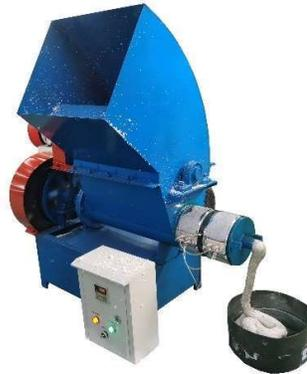
*Gambar 3. 3 Mesin pelumer plastik*
