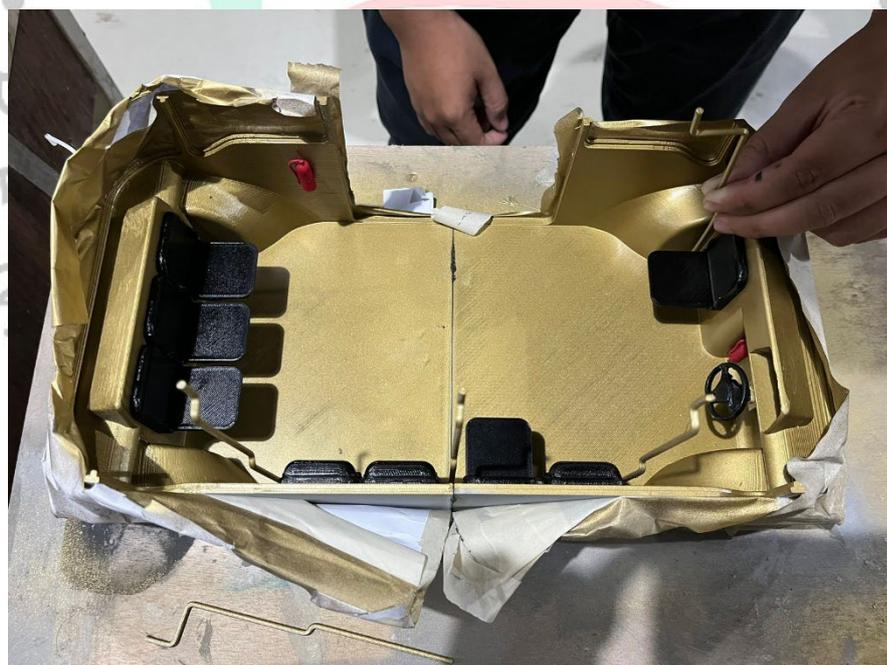
**Gambar 4.39** Proses pemasangan komponen interior (*dok.pribadi*)
