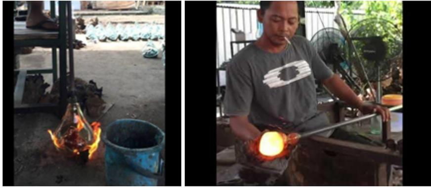
*Gambar 2.11 Proses Pembuatan kaca tiup (Martono, 2021*
