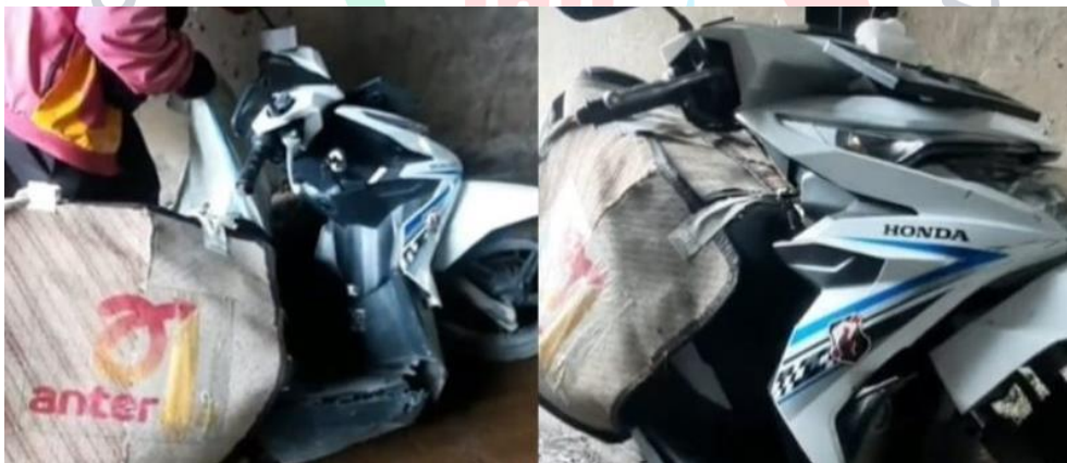
Gambar 2. 7 : Sepeda motor kurir anteraja yang rusak karena kelebihan muatan
