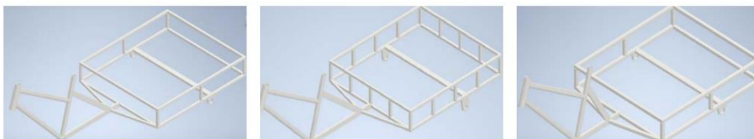
Gambar 2. 5 : Rangka 20x20cm; 20x20cm reinforced; rangka 25x25cm
