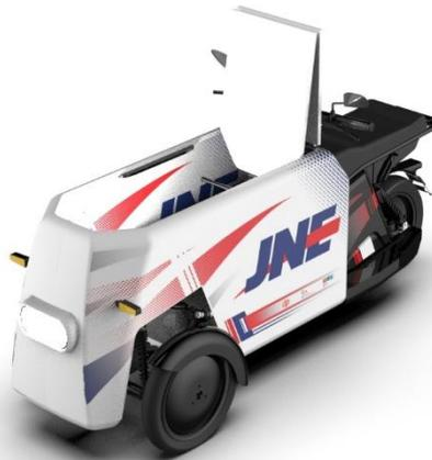
**Gambar 4.19: Konfigurasi Dengan Cargo Terbuka**
