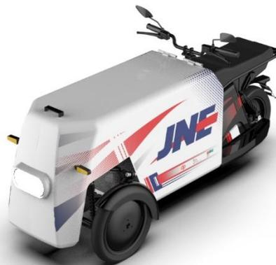
**Gambar 4.19: Konfigurasi Dengan Cargo Tertutup**
