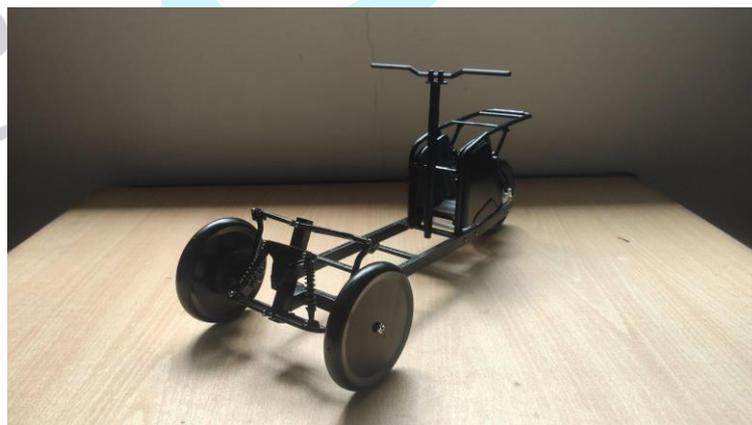
**Gambar 4.19: Komponen – Komponen Cargo Bike ketika sudah dirakit**
