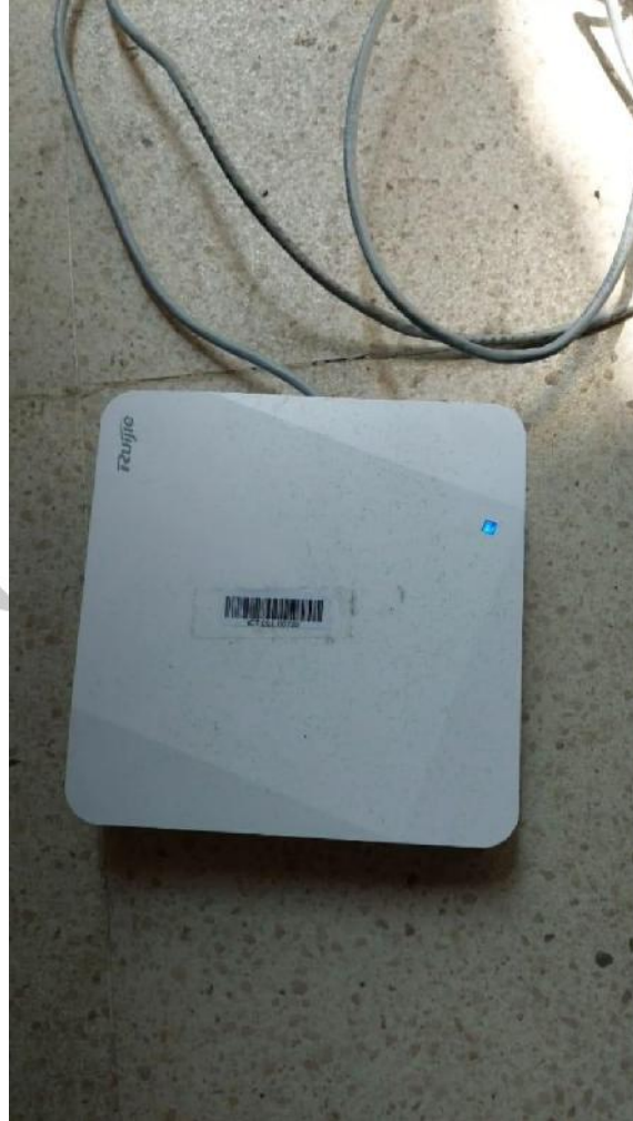
Gambar 3.12 Access point yang sudah dinyalakan dan terhubung kembali ke jaringan.
