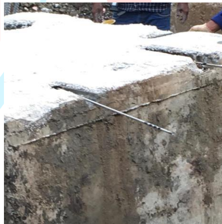
Gambar 3. 99 Pipa telltale yang dimasukkan melalui pile cap
