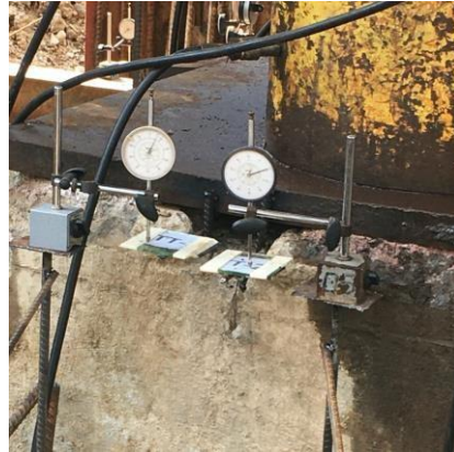
Gambar 3. 103 Pemasangan dial gauges untuk membaca pipa telltale
