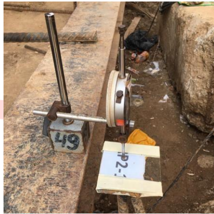
Gambar 3. 101 Pemasangan dial gauges untuk membaca gaya tarik reaction pile
