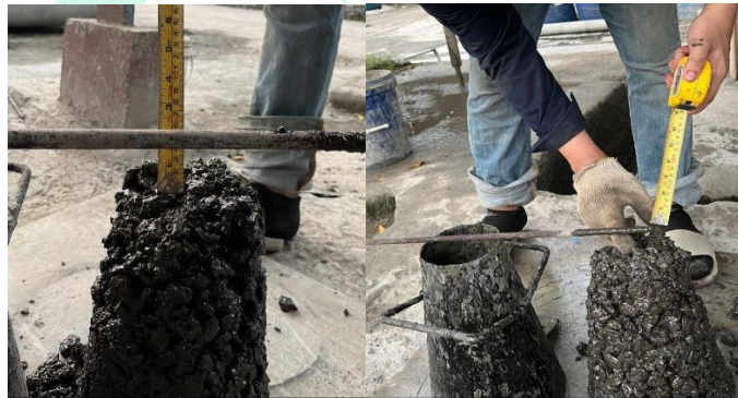
Gambar 4. 3 Pengujian Slump pada Beton Geopolimer
