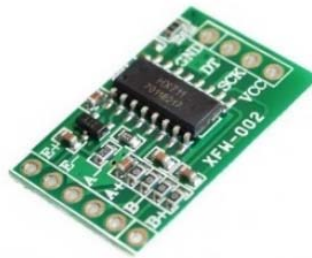
Gambar 2. 5 Bentuk Fisik Modul HX711
