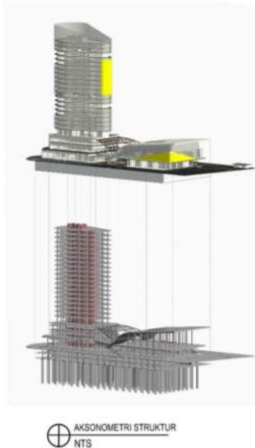
Gambar 5.15 Aksonometri Struktur (Sumber: Penulis, 2024)
