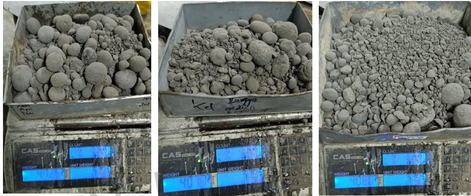
Gambar 4. 16 Hasil Pengujian Los Angeles variable 10%
