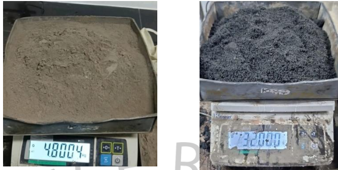
Gambar 4. 2 Rasio fly ash, silica fume 0%, pasir, dan alkali activator
