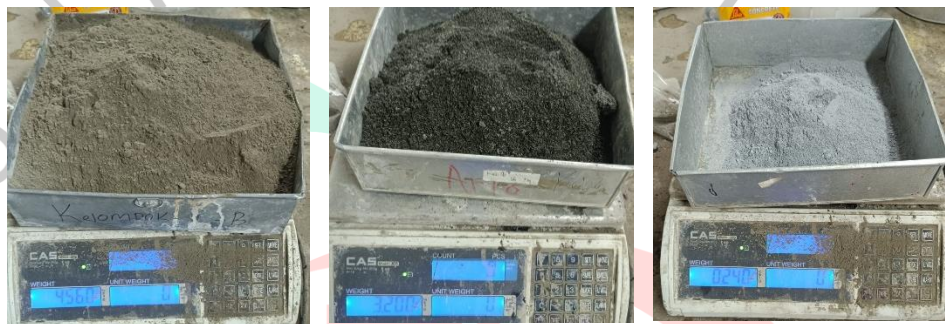
Gambar 4. 3 Rasio fly ash, silica fume 5%, pasir, dan alkali activator
