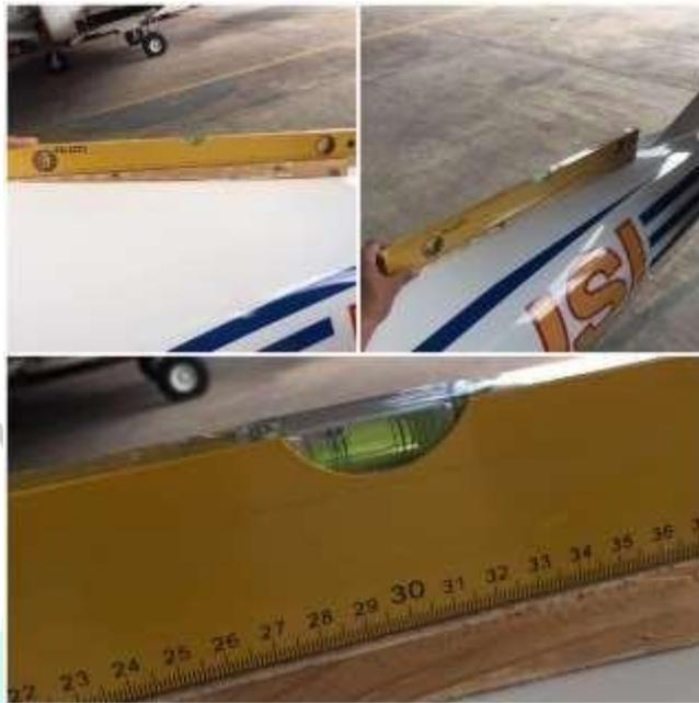
*Gambar 3.10 Melakukan Waterpass Bagian Ekor Pesawat Diamond DA-40 TDI*
