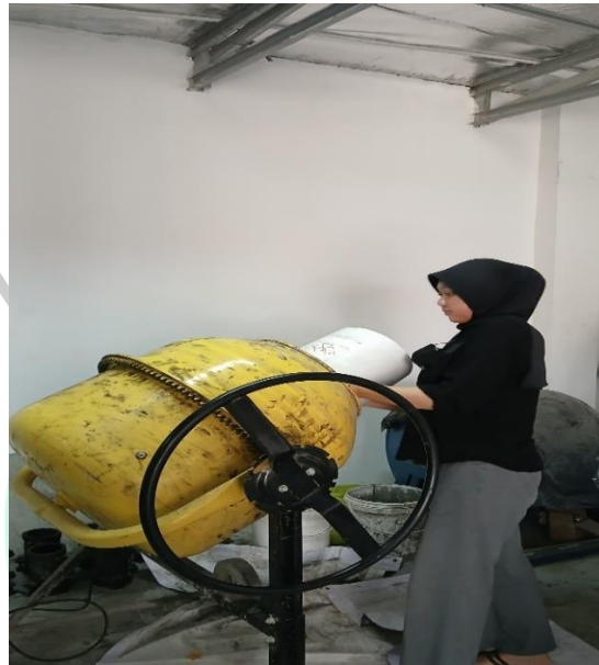
Gambar 4. 4 Proses Pembuatan Beton
