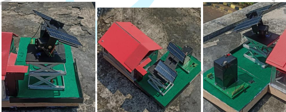
Gambar 5. 1 Foto Prototipe Sistem Dual Axis Solar Tracker
