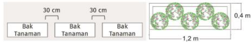
Gambar 2. 35 Dimensi Pemasangan Planter Box
