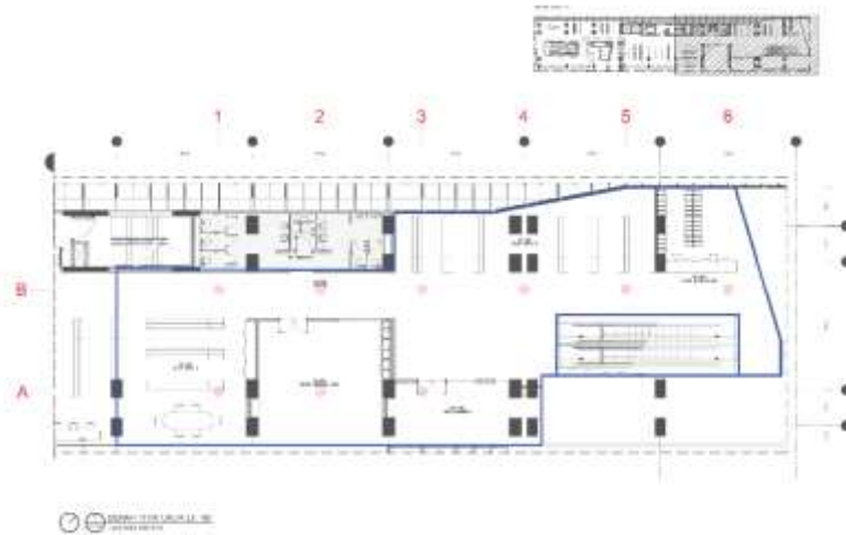
Gambar 4.30 Denah Titik Ukur Pencahayaan Buatan Perpustakaan Lantai 4B
