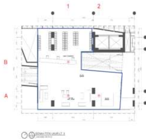
Gambar 4.26 Denah Titik Ukur Pencahayaan Buatan Perpustakaan Lantai 3
