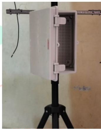
Gambar 5. 4 Box Panel untuk meletakkan Arduino
