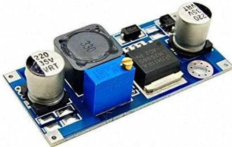
Gambar 2. 17 Penurun tegangan dc-dc
