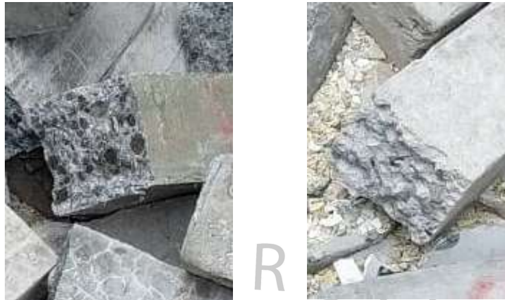
Gambar 4. 10 Perbandingan Agregat Buatan (kiri) dan Agregat Alami (kanan) setelah Pengujian
