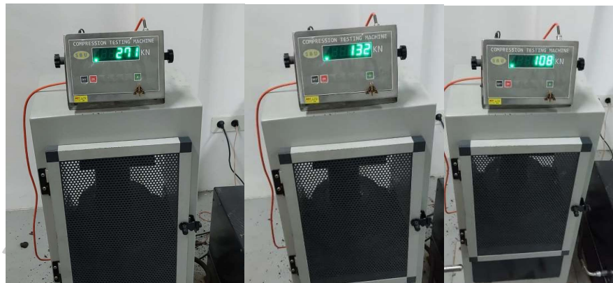
Gambar 4. 4 Hasil Uji Kuat Tekan Sampel Agregat (Trial & Error)
