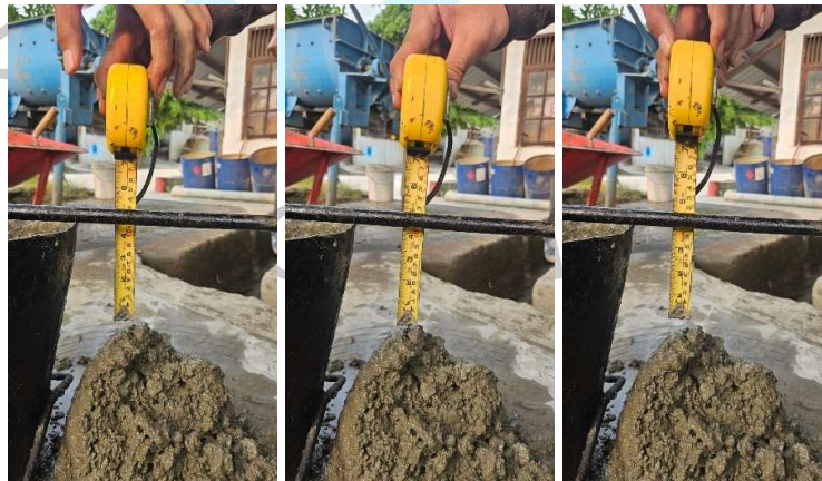
Gambar 4. 4 Pengujian Slump pada Beton Campuran Terak Baja
