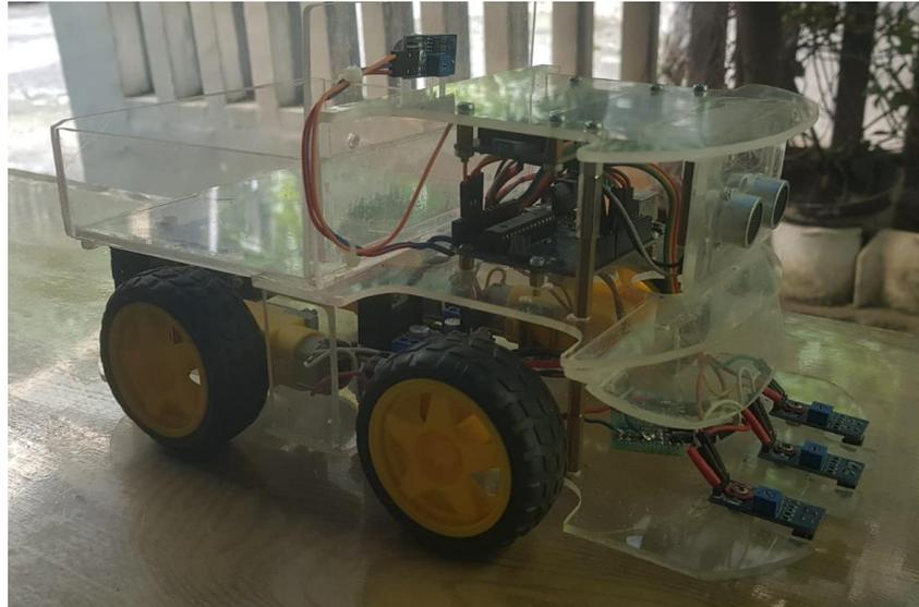
**Gambar 5.6 Perakitan Rangkaian Keseluruhan Protipe Robot**
