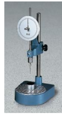
Gambar 3. 22 Alat untuk Penetration Test (Source: Google)
