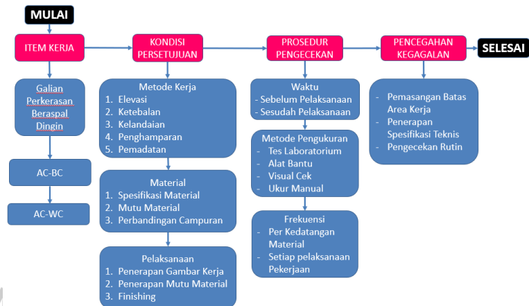
Gambar 3. 35 Metode pengendalian mutu pada proyek rasuna said
