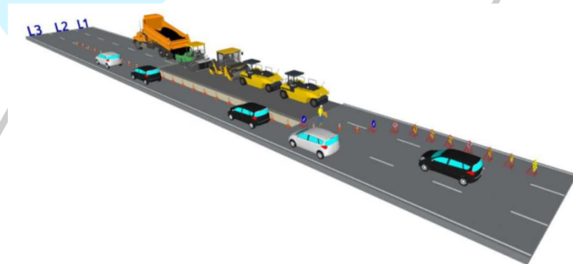
Gambar 3. 24 Salah Satu Gambar Perencanaan Penggelaran Aspal (Lapisan AC-BC) (Sumber: Dokumen Proyek Jalan Rasuna Said, 2023)
