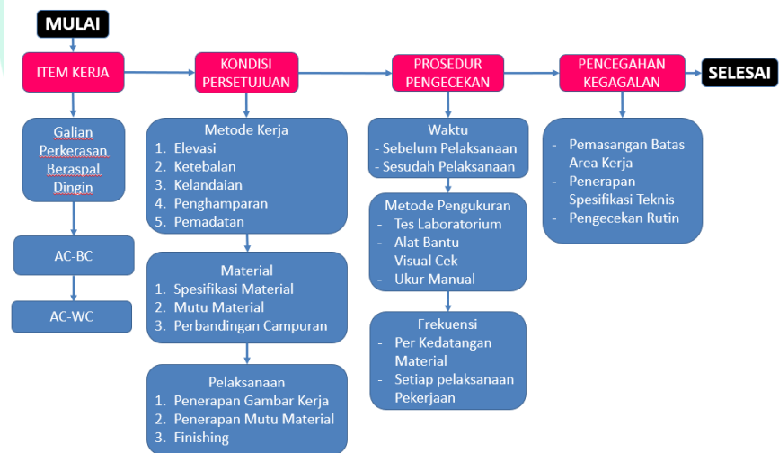
Gambar 3. 27 Metode Pengendalian Mutu pada Pekerjaan Perbaikan Jalan Rasuna Said
