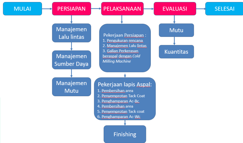
Gambar 3. 18 Metode Kerja pada Proyek Pekerjaan Perbaikan Lapisan AC-WC dan Lapisan AC-BC di Jalan Rasuna Said DKI Jakarta (Sumber: Dokumen Proyek Jalan Rasuna Said, 2023)
